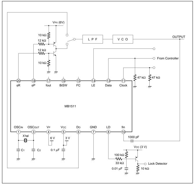
$V_{\text{PX}},\,V_{\text{P}}$  : 8 V max.
